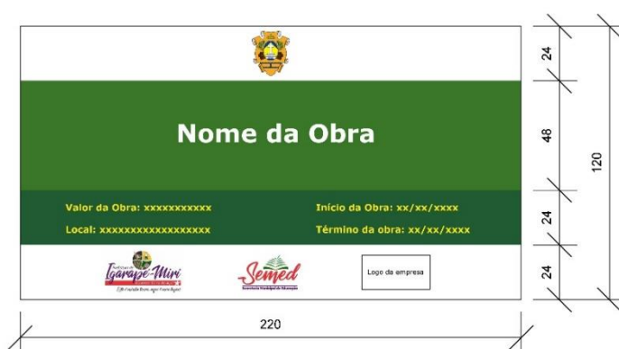
Figura 1: Modelo de placa de obra
