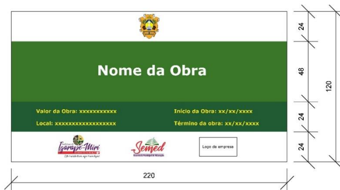
Figura 1: Modelo de placa de obra
