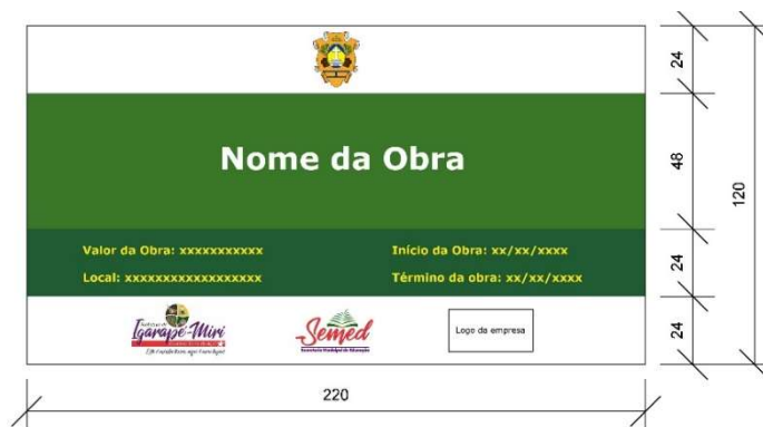
Figura 1: Modelo de placa de obra
