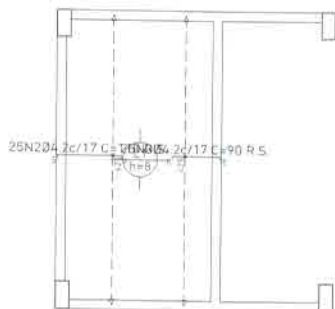
Piso 2 Armadura longitudinal superior Concreto: C25, em geral CA-50 e CA-60 R.S. Reforço superior Escala: 1:75
