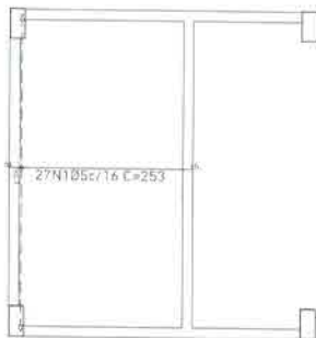
Piso 2 Armadura longitudinal inferior Concreto: C25, em geral CA-50 e CA-60 Escala: 1:75
