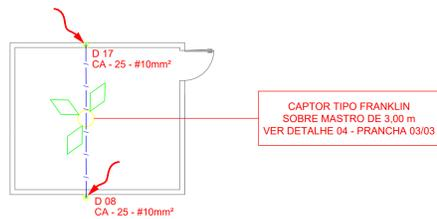
PARA FIXAÇÃO DOS CABOS NA TELHA METÁLICA E DESCIDA VER DETALHE 08 E 09 - PRANCHA 03/03
